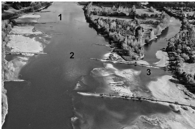
Photo 2 - Chevette (3), seuil (2) et épis (1) immédiatement en amont de la ville d'Ancenis (cliché : GIP Loire-estuaire, vue aérienne prise d'Ancenis vers le nord-est)
